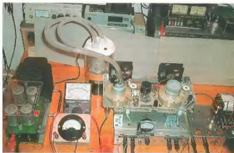
Overzicht op de opstelling met van links naar rechts: hoogspanningsvoeding, meting, koeling, eindtrap en de gloeispanningsvoorziening.
